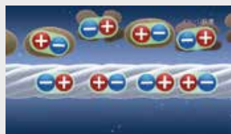
汚れと繊維の間に引き合う力がなくなり、汚れが取れます
