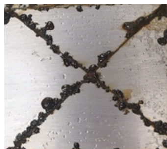
塗膜部分に錆は発生していません。 (塗膜に切り込みを入れた部分のみに錆が発生)
